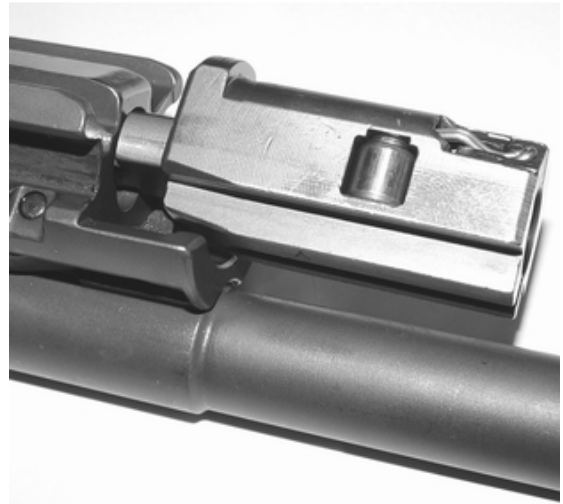
Verschlusskopf auf das Steuerstück schieben und um 45 Grad nach links drehen.
