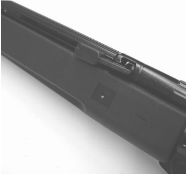
Durchladehebel nach hinten ziehen.
