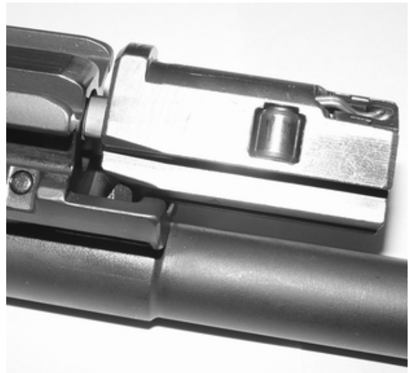
Verschlusskopf etwa 3mm vom Verschlussträger zurückziehen.
