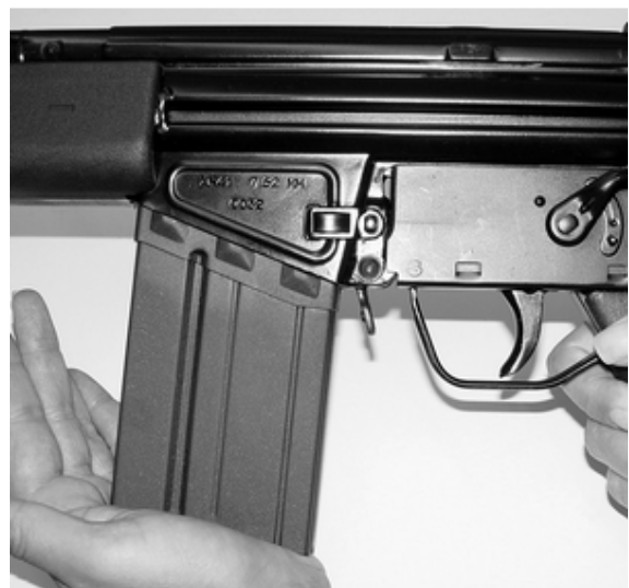
Magazin einführen bis es einrastet.
