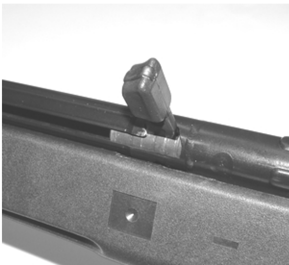
Durchladehebel in der Durchladehebelraste arretieren.
