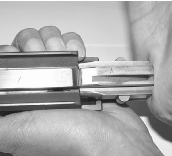
Verschlusskopf an/in den Verschlusssträger drücken
