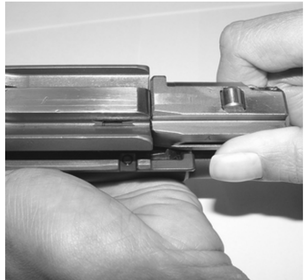
Verschlusskopf eine Viertelumdrehung (90 Grad) nach links drehen.
