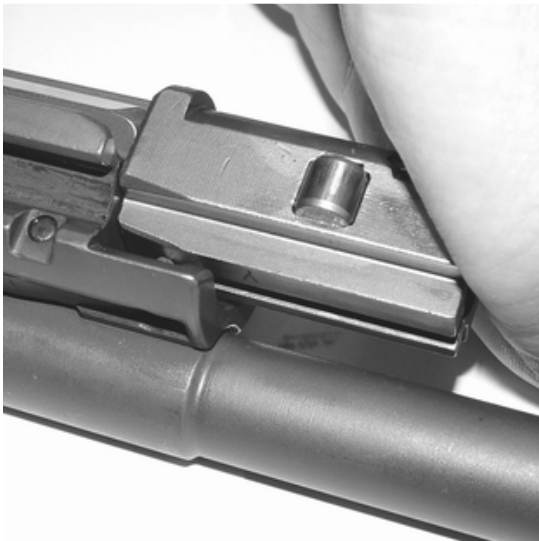
Verschlusskopf auf das Steuerstück und damit an den Verschlussträger drücken.
