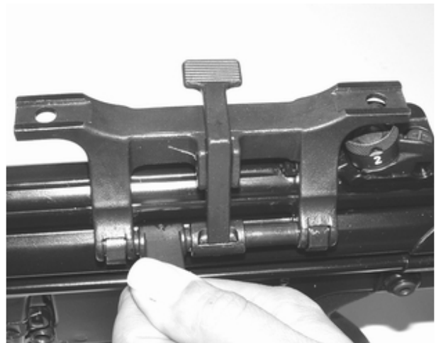
Festklemmhebel nach unten ziehen bis der Montagehaltehebel hörbar einrastet.
