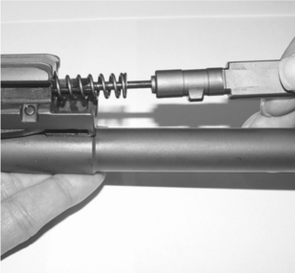
Steuerstück aus dem Verschlussträger ziehen.
