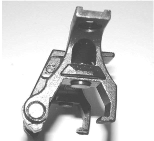
Halteklauen der Montage nach außen stellen.
