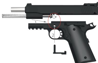
Posuňte závěr zcela dopředu a posuňte manuální pojistku do polohy zajištěno.
