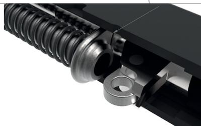
Držte závěr tak, abyste viděli otvor v článku hlavně skrz otvor pro záchyt závěru.
