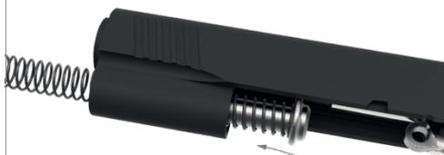
Umístěte zaoblenou část vodítka vratné pružiny na vnější povrch hlavně přímo před článkem hlavně.
