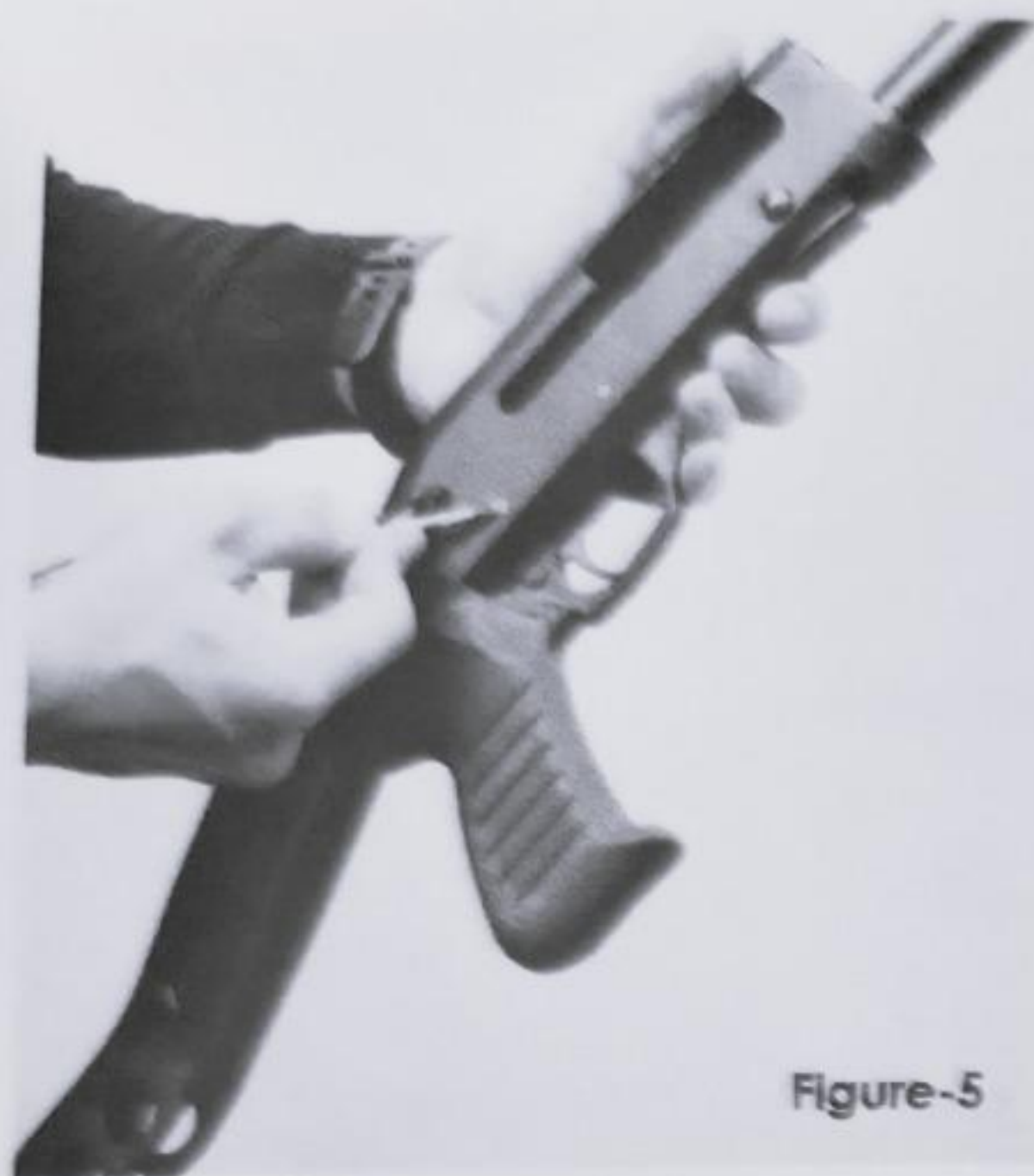
Obrázek 5 (Figure-5) Zatlačte čep zobrazený na obrázku pomocí napínací páky závěru.
